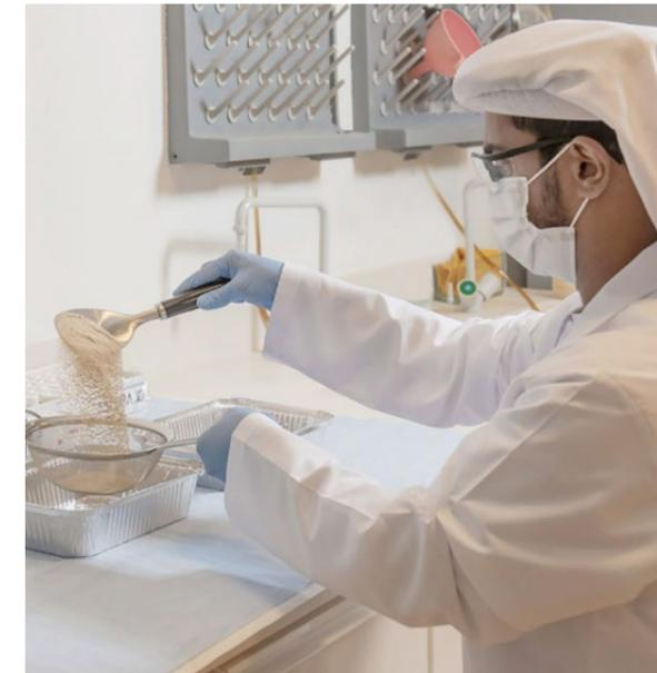
لدى المختبر إجراءات تشغيلية قياسية معتمدة لتحضير العينات وتحليلها وهي طريقة التحليل الغير المدمرة التي يتم قياسها باستخدام كاشف طيف جاما (HPGe). جميع العينات التي يتم جمعها يتم تحضيرها وتحليلها في المختبر وفقاً لإجراءات تشغيلية قياسية معتمدة لمعمل الهيئة.
